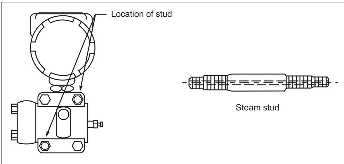
Fig. C.1.5-3. Steam stud arrangement
